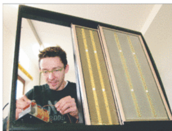
Cheftechniker Marco Weber setzt einen elektrostatischen Lautsprecher im Atelier zusammen. ■ Fotos: Jochen Magnus
